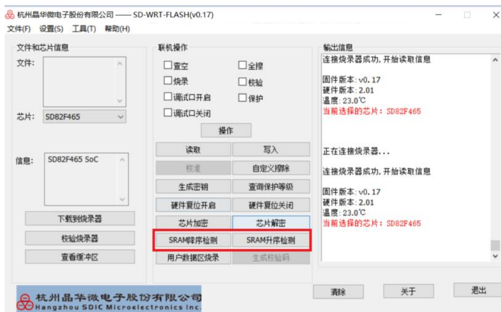
图 4.9.1 SD82F46X 芯片在线 SRAM 检测操作
