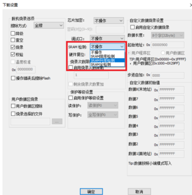
图 4.9.2 SD82F46X 芯片离线 SRAM 检测操作
