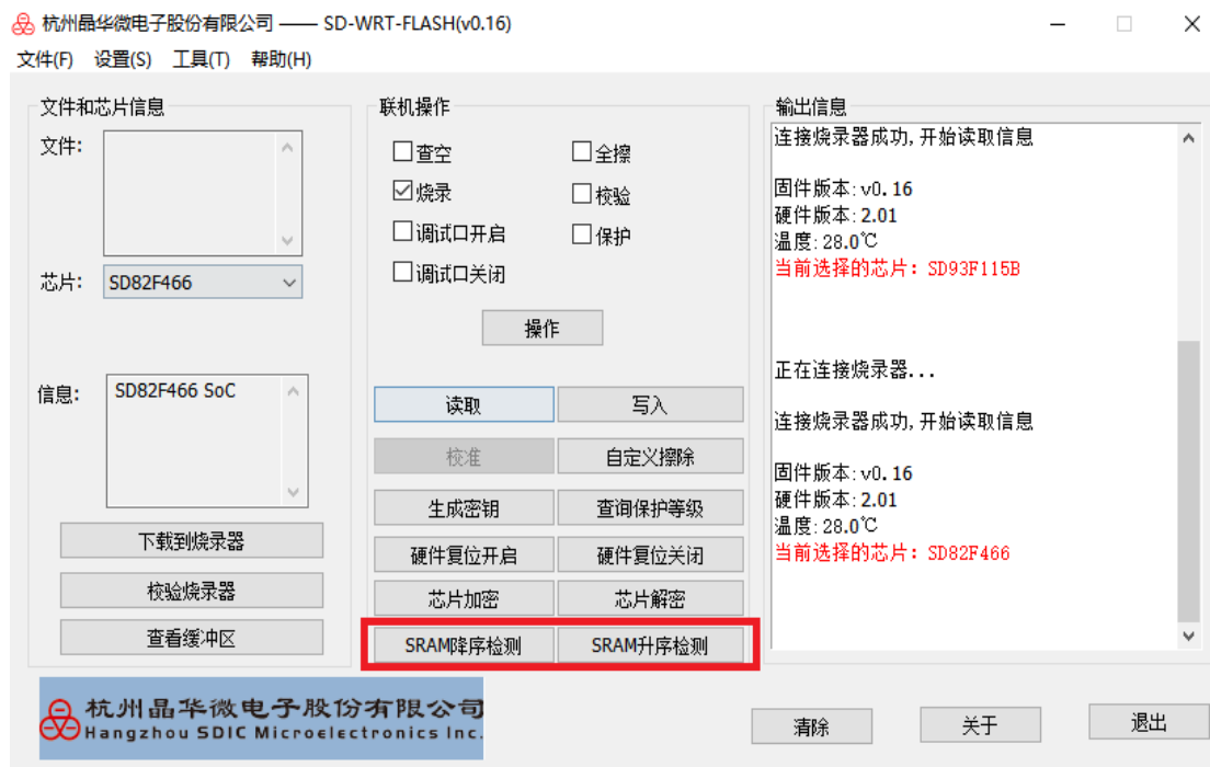
图 4.9.1(SD82F46X 芯片在线降序升序操作)
